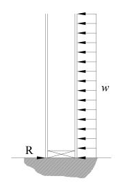
FIGURE 2—ZERO BEARING SUPPORT
