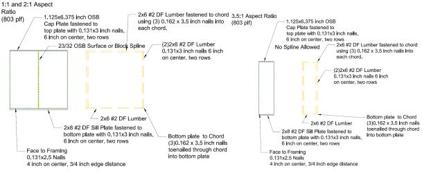
FIGURE 5—TABLE 13 SHEARWALL CONSTRUCTION (803 PLF)
