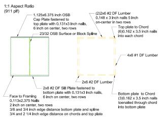
FIGURE 4—TABLE 13 SHEARWALL CONSTRUCTION (911 PLF)
